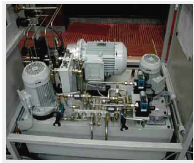
تصویر شماره 2: مخزن، موتور الکتریکی و پمپ یک سیستم هیدرولیکی
