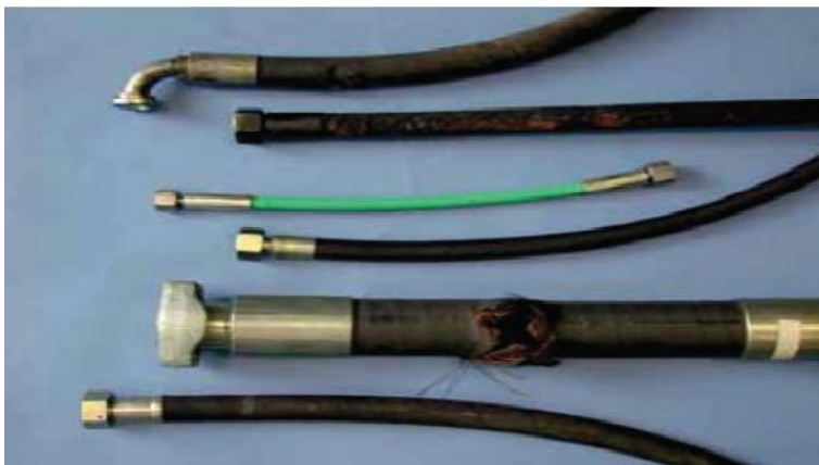
تصویر شماره 4: قسمتی از شیلنگ یک مدار هیدرولیک که دچار شکست شده است
