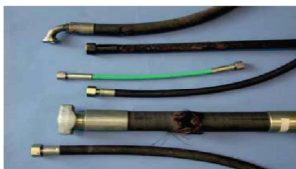
شکل 6) قسمتی از شیلنگ یک مدار هیدرولیک که دچار شکست شده است
